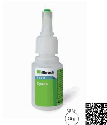
Adesivo instantâneo líquido e monocomponente à base de cianoacrilato de etilo que endurece em segundos com a humidade, o CY011 permite a colagem rápida de uma grande quantidade de metais, plásticos (exceto PP/PE, PTFE, silicone), elastómeros, vidro, pedra, porcelana, madeira e PVC. Na carpintaria permite a colagem de juntas de EPDM e os seus acessórios.
