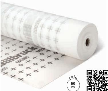
A ME005 é uma barreira de vapor destinada a assegurar a estanqueidade em coberturas internas e a limitar a difusão do vapor de água nas paredes. É composta por uma membrana funcional na parte central, com a adição de um rebordo de reforço revestido de ambos os lados por uma camada não tecida de polipropileno. A ME005 permite a implementação da estanqueidade na construção de coberturas com estrutura de madeira.
