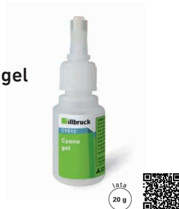
Adesivo instantâneo em forma de gel e monocomponente à base de cianoacrilato de etilo que endurece em segundos com a humidade, o CY012, permite uma colagem rápida de superfícies porosas como a madeira, o papel ou o cimento. Apto também para metais e plásticos.
