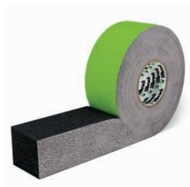
Espuma de poliuretano com uma película autoadesiva, impregnada com uma resina sintética estável, assegura, por si só, a estanqueidade ao ar e a impermeabilização sob o impacto da chuva (600 Pa). O illmod Trio "3 em 1" é um excelente isolante térmico e acústico e apresenta uma permeabilidade ao vapor de água controlada com o objetivo de evitar os riscos de condensação na junta sejam quais forem as condições climáticas.
