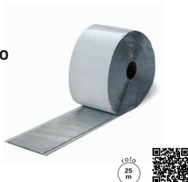
Membrana composta por uma massa de butilo com grande poder adesivo que cobre uma película não arrancável formada por alumínio e materiais sintéticos. Utiliza-se nas uniões estanques de telhados, galerias, envidraçamento, fachadas ligeiras (muros cortina), carpintarias exteriores, espelhos e juntas de cúpulas.
