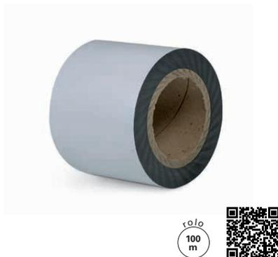
Rolo de película protetora de alta resistência e baixa espessura (65 micrones) em polietileno, revestido com uma resina elaborada a partir de borracha natural para aplicação manual. A face adesiva é de cor preta e a oposta de cor branca para permitir a marcação.
