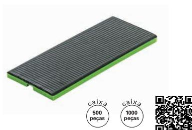
As cunhas de envidraçamento universal consistem numa base de plástico rígido, revestida com uma superfície lisa e estriada para absorver os movimentos e golpes do vidro isolador e assim evitar danos. Estas cunhas podem ser aplicadas em superfícies planas e proporcionam a drenagem graças ao seu canal inferior.
