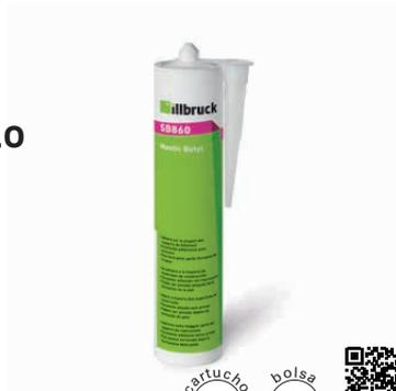
Selante à base de polibutileno que seca em superfície para formar uma camada firme e lisa, mas que permanece pastosa no interior da massa. Utiliza-se para juntas estáticas ou de pouco movimento ou como junta de estanqueidade (construção metálica, juntas desmontáveis).
