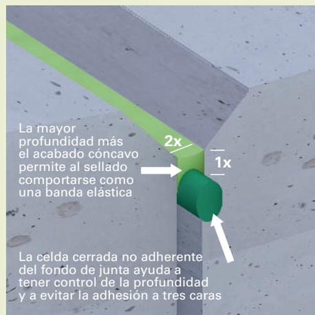
Junta entre paneles prefabricados de hormigón
