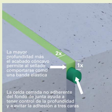
Junta de control en suelo de hormigón
