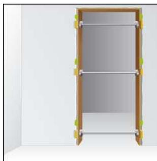
Etayage lors du montage de châssis.
