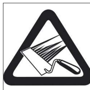
Fig. 6: sur le côté non-tissé de la membrane vous retrouvez le sigle repris ci-dessus. Il indique le côté à enduire de mortier
