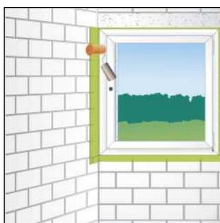
Fig. 5: fixer la membrane sur le mur
