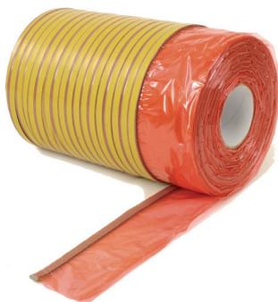
Cette bande pour joints cousue dans une feuille est utilisée pour l'étanchéité à l'air des joints de raccordement de fenêtres à l'intérieur. La bande est activée au moment voulu au moyen d'un fil de déchirement.
