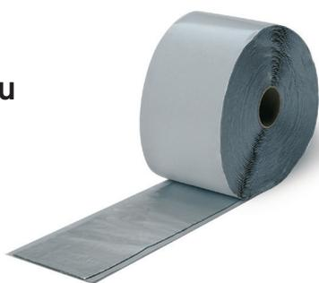
Cette bande autocollante unilatérale peut-être utilisée dans les travaux de recouvrement, réparation ou rénovation de raccords, joints, marques de coups et chevauchements, en intérieur comme en extérieur, lorsqu'une isolation étanche à l'air et à la vapeur d'eau est nécessaire (par ex. : fenêtres et façades). Dans certains cas, une couche de primaire peut être nécessaire.
