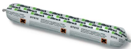
Cette colle à membranes EPDM à base de caoutchouc styrène, résistante aux solvants, est utilisée pour le raccordement de membranes EPDM illbruck ou leur collage sur les supports courants, tels que le béton, les éléments de construction, le bois, l'aluminium, l'acier, ou encore de nombreux types d'enrobé à froid.
