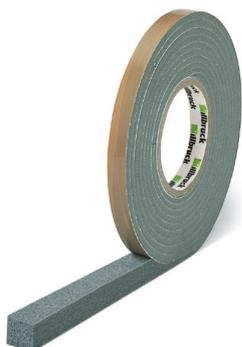
Cette bande pour joint convient pour les constructions de joint telles que les raccords de fenêtres, les joints de raccordement de fenêtres cachés ou comme limite de joint d'étanchéité. Le TP300 peut également être utilisé comme ruban de remplissage, en particulier dans la construction métallique. Dans cette fonction, il remplit les exigences en matière d'étanchéité au vent et d'isolation thermique. Correspond au type 2 selon la fiche technique IFBS.
