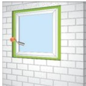
Bild 2: Verwenden Sie einen Andruckroller
