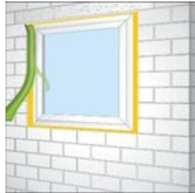
Bild 1: Verklebung mit dem Baukörper
