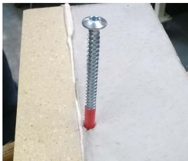
Beton, MW-Abstand < 5 mm
